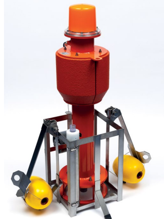
Bouée d'observation du niveau de l'eau
